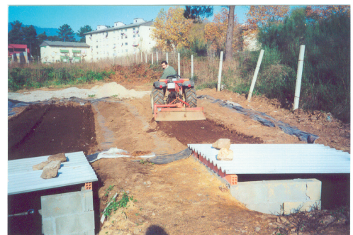
Figura 2. Remoción de las parcelas experimentales sometidas a landfarming , mediante laboreo con tractor.
