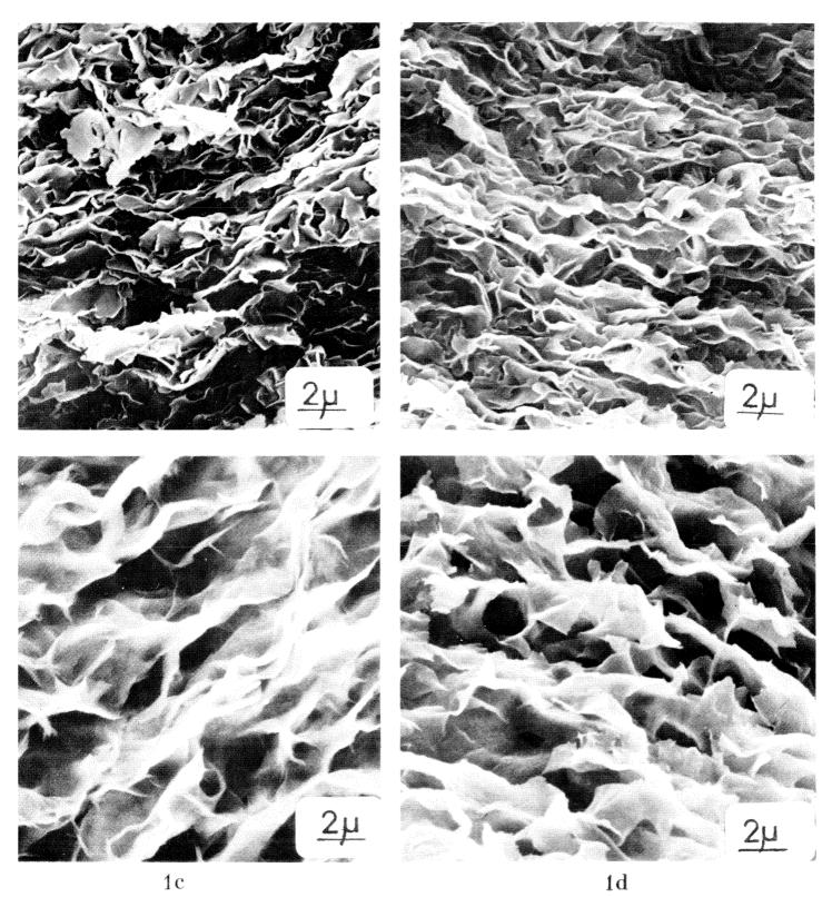
'hotos 1 — Montmorillonite Na, NaCl<br/> N, pF 3, 264 % d'eau — G x 5000
